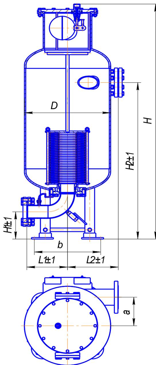
Нижний выходной патрубок имеет регулировку через каждые  $90^{\circ}$  на  $360^{\circ}$ .
