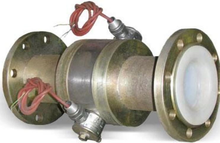
Клапан предназначен для ступенчатого регулирования расхода и открытия (закрытия) проходного сечения трубопровода с целью обеспечения безопасной технологии налива автомобильных или железнодорожных цистерн неагрессивными нефтепродуктами (клапан электрогидравлический) вязкостью от 0,55 до 60 мм<sup>2</sup>/с с рабочим давлением до 0,6 Мпа.
