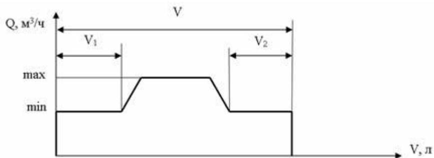
$V$  - заданная доза, л;  $V_1$ ,  $V_2$  - прошедшие объемы нефтепродукта, на минимальном расходе, в начале и конце заданной дозы, л. Величина минимального расхода устанавливается потребителем и задается с управляющего устройства (КУП).
