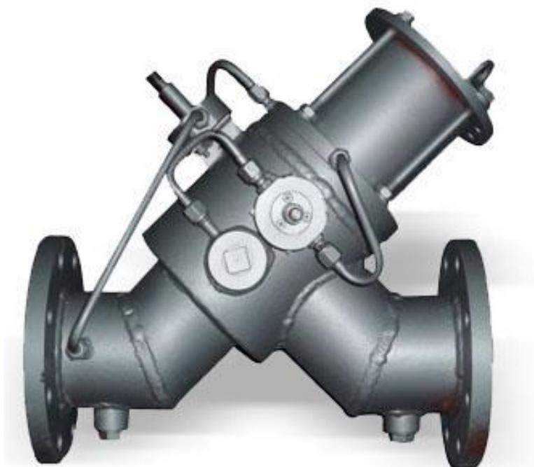
Клапан осесимметричный предназначен для дистанционного (при помощи центрального блока управления), либо местного (при помощи позиционера) регулирования расхода, частичного или полного открытия (закрытия) проходного сечения трубопровода с целью обеспечения безопасной технологии налива автомобильных или железнодорожных цистерн неагрессивными нефтепродуктами вязкостью от 0,55 до 60 мм<sup>2</sup>/с с рабочим давлением до 0,6 МПа.
