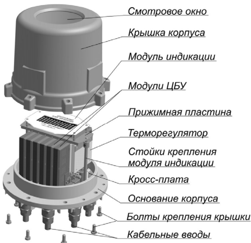
Рисунок 2 –Компоновка ЦБУ
