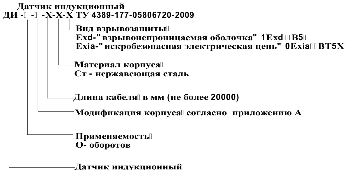
**Рисунок 1-** Схема записи условного обозначения датчиков индукционных оборотов.
