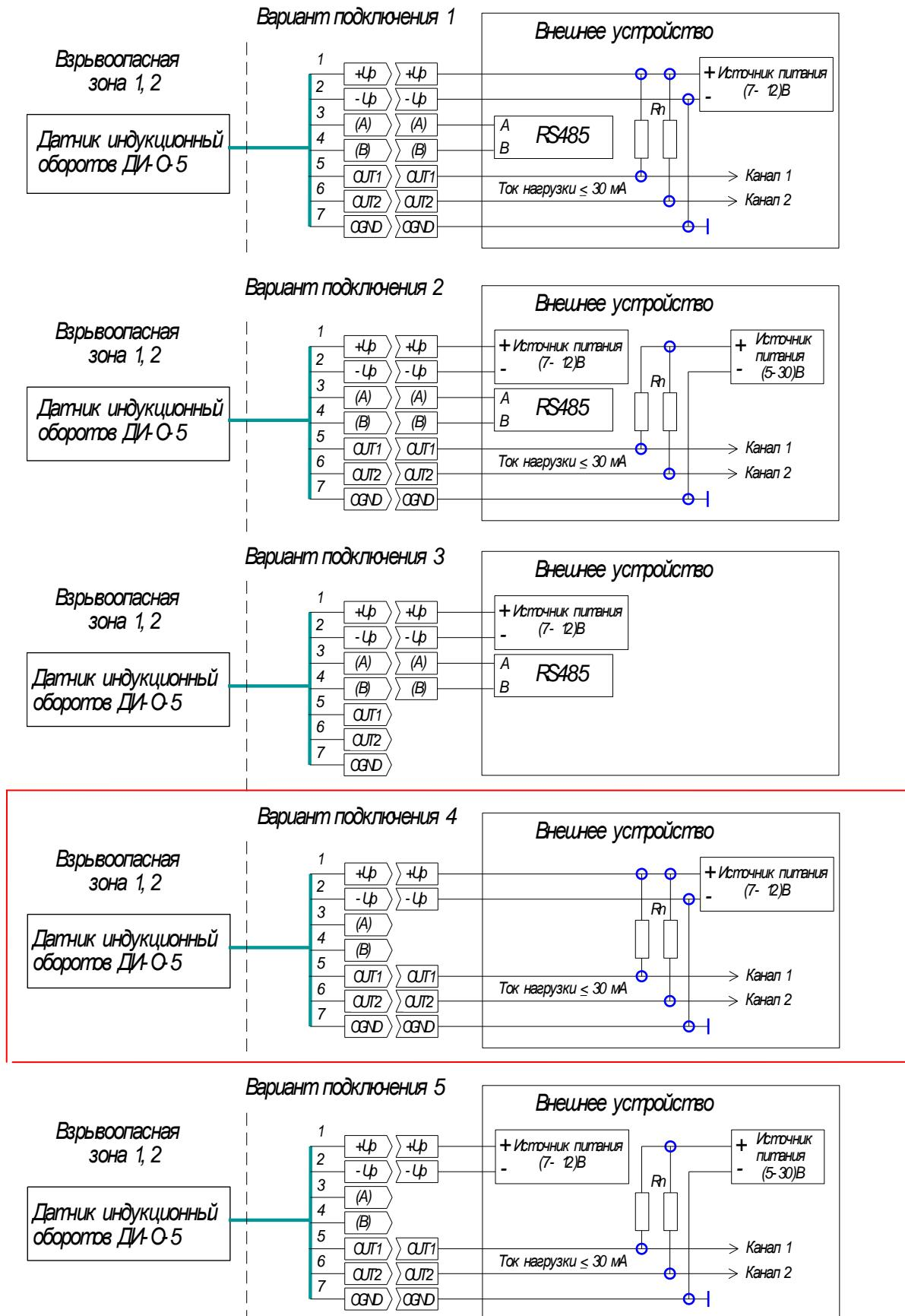
**Рисунок А.3 - ДИ-О-5. Схема электрическая подключения для зон "взрывобезопасная", взрывоопасная "1" и взрывоопасная "2"**
