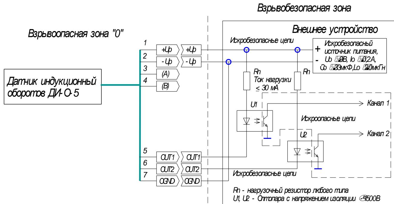
**Рисунок А.4 - ДИ-О-5. Схема электрическая подключения для взрывоопасной зоны "0".**
