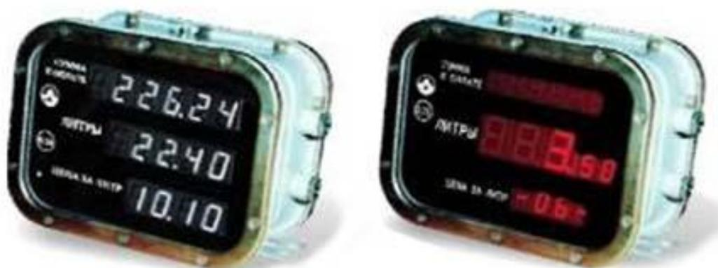
Контроллер КУП - интерфейсное отсчетное устройство, предназначено для управления топливораздаточными и газонаполнительными колонками. На индикаторах контроллера отображаются значения суммарного и разового количества дозы, цены, номера поста, состоянии, в котором находится ТРК.
