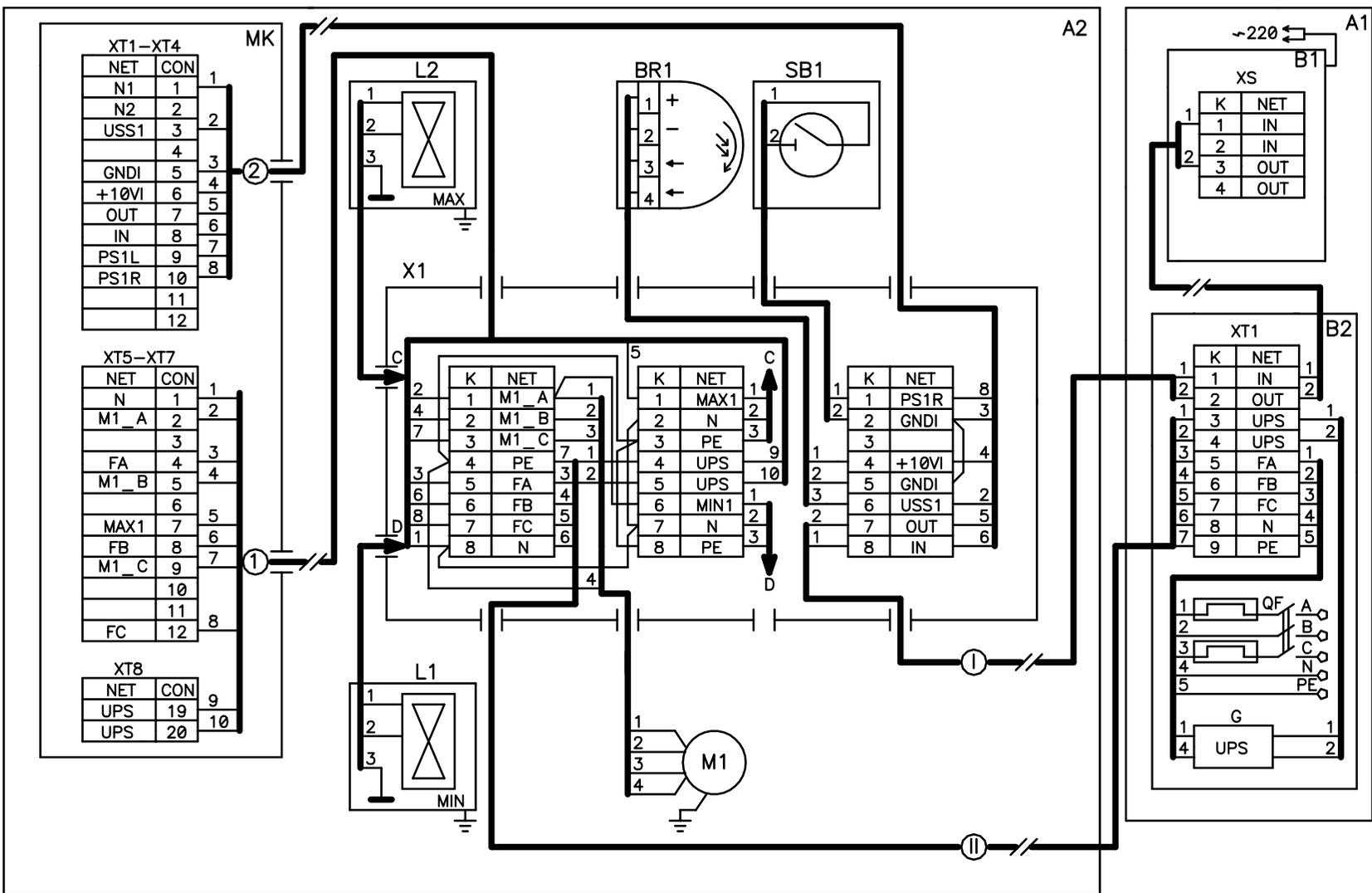
Рисунок А.1 Схема подключения ТРК 1КЭД «Ливенка-11101», оснащенной контроллером КУП-2 (КУП-4, КУП-6).
