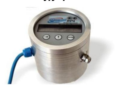
Датчики "ЛУЧ" входят в состав расходомеров-счетчиков, предназначеных для измерения объема нефти и нефтепродуктов на технологических установках нефтедобывающих и нефтеперерабатывающих предприятий.
