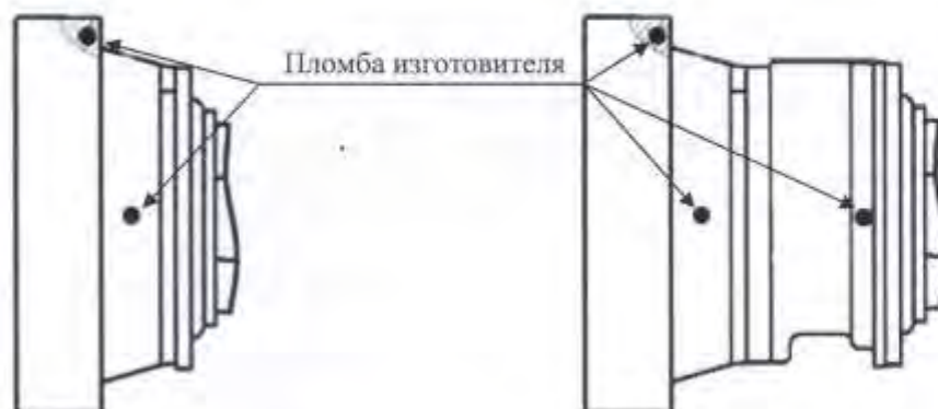
Рисунок 14 – Схема пломбировки ВП СУ
