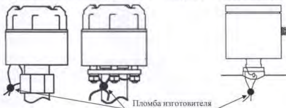
Рисунок 17 – Схема пломбировки ВП ЛУЧ-01 и ЛУЧ-02
