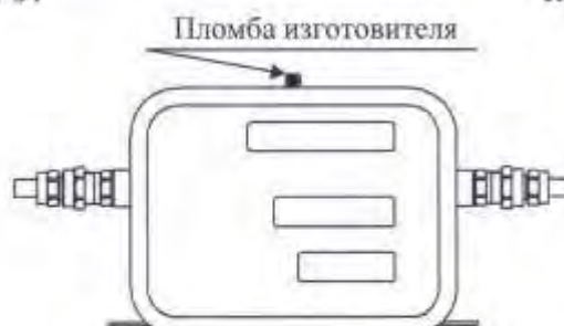
Рисунок 20 – Схема пломбировки КУП
