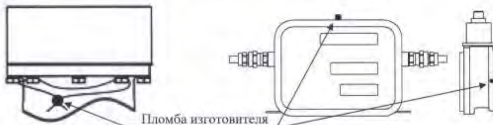
Рисунок 18 – Схема пломбировки ВП ЛУЧ-03 и ЛУЧ-04
